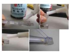
Промажьте клеем места соединений дюралайта с электрошнуром и с защитным изоляционным колпачком. Можно использовать клей серий <u>3M DP8XX и 3M DP8XXX</u> или <u>3M80 и 3M90.</u> <u>www.glues.ru</u>
